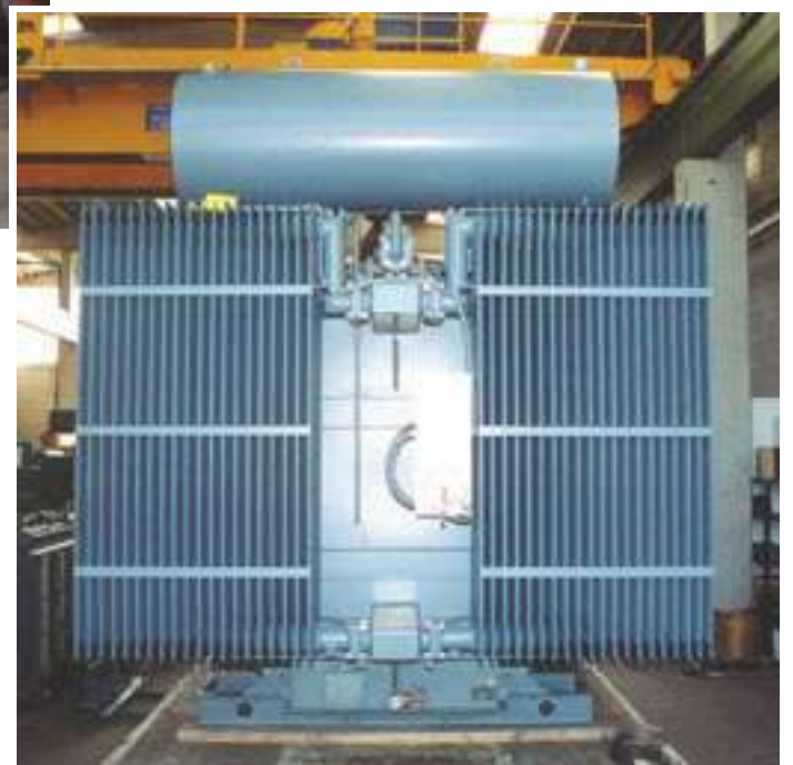
TRASFORMATORE MONTATO - ASSEMBLED TRANSFORMER
