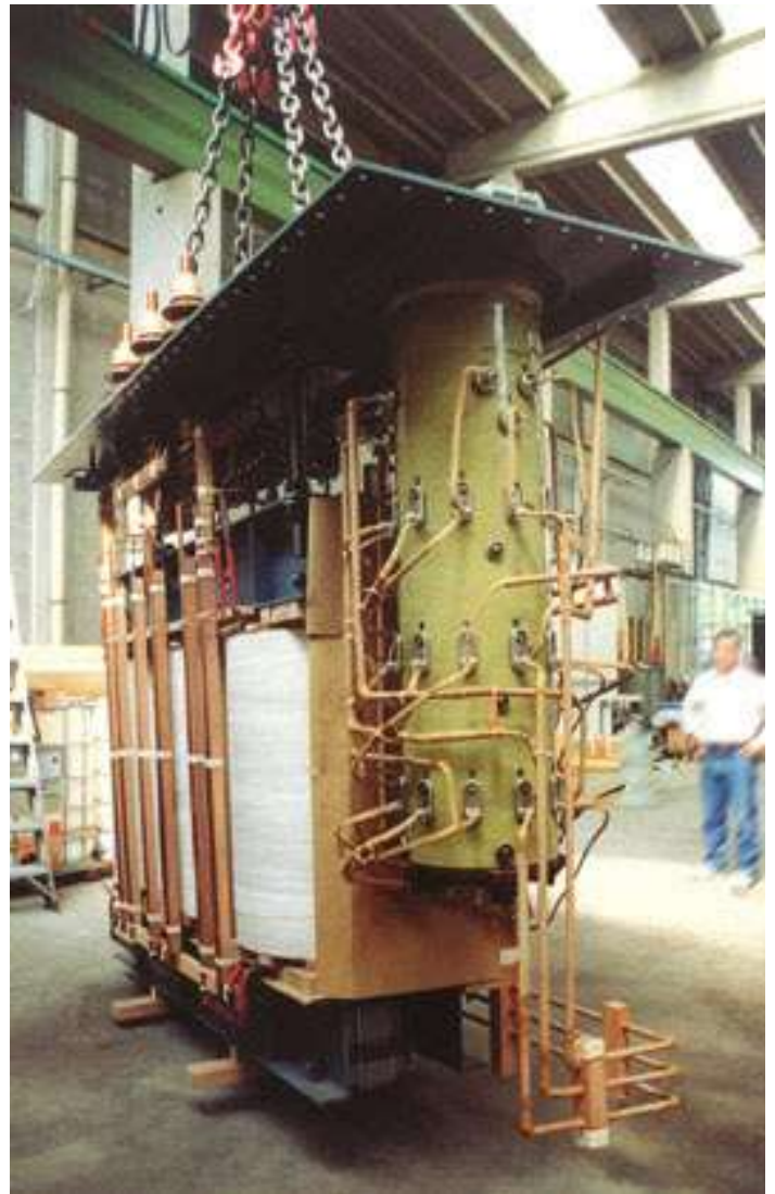
16 MVA kV 33 ± 9x1,25% PARTE ESTRAIBILE - ACTIVE PART
